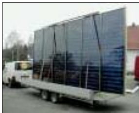
Die HFK-Großflächenkollektoren bis 21 m 2 sind als Kranmodul oder als Bau-satz lieferbar.
